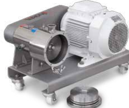
Çok dişli hızlı karışım mixer High shear "multitooth" mixer.
